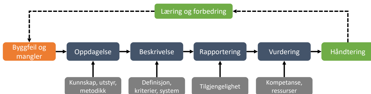
Figur 4.2 Forutsetninger for en korrekt håndtering av byggfeil
