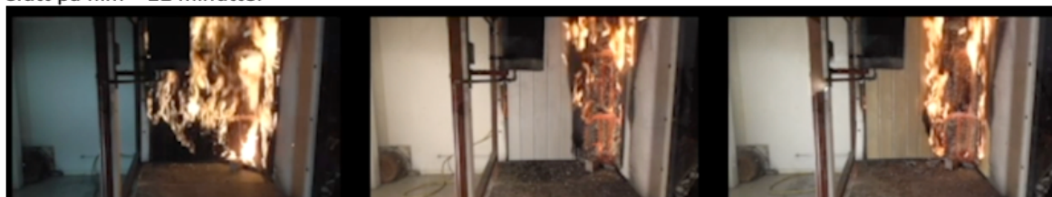
Figur 5.6 Bilder tatt fra filmen av branntester av royalbehandlet trekledning, malt trekledning beiset trekledning
