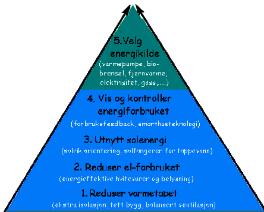
Figur 1 "Kyotopyramiden" - fremgangsmåte ved "passiv energidesign".
