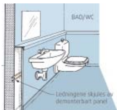
Eksempel på veggmonterte sanitærinstallasjoner med skjult rørføring
