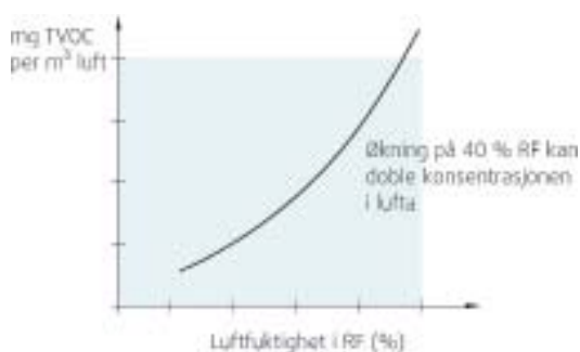
Påvirkning av fukt på innholdet av TVOC i lufta
