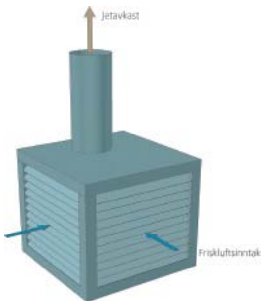
Eksempel på kombinert hatt for luftinntak/avkast for småhus og mindre bygninger
