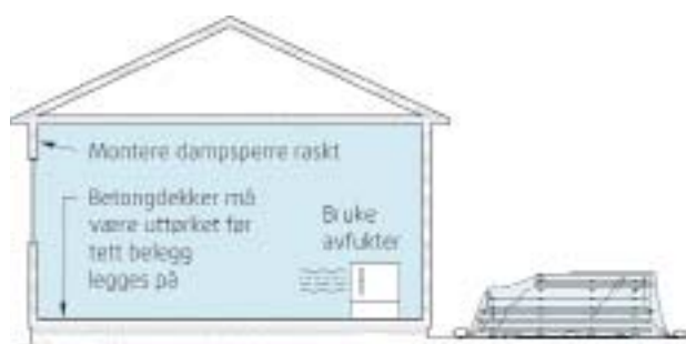
Eksempel på viktige tiltak for å unngå problemer med byggefuktighet
