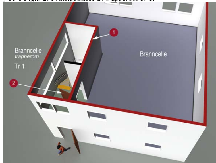
§ 11-8 Figur 2: Prinsippskisse av trapperom Tr 1.
