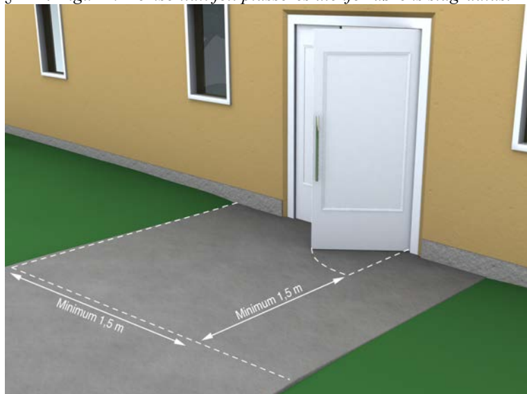
§ 12-4 Figur 1: Horisontalt felt plasseres utenfor dørens slagradius.
