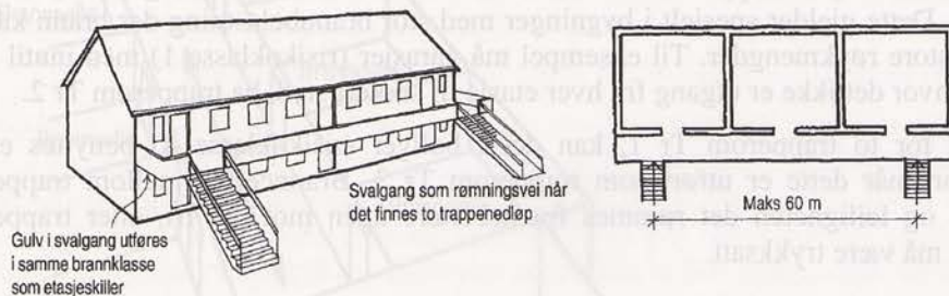
§ 7-27 fig. 20 Brannbeskyttelse av rømningstrapp fra svalgang
