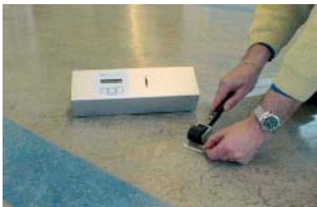
Et støvmessig godt innemiljø kan sikres ved å stille krav til maksimumsnivåer for støv på overflater og kontrollere rengjøringskvalitet ved hjelp av støvmålinger. Foto: SINTEF Byggforsk
