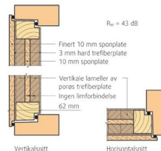
Fig. 434 Eksempel på dør med lydstrålminskende kledning utenpå. Dørbord med kjerne av bygningsplate og tosidige lameller av porøs trefiberplate. Dør med overfals, dobbelt anslag og to sett med tettelister
