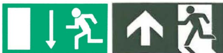
Figur 3-2: Illustrasjon av konflikten mellom skilt i henhold til arbeidsplassforskriften (til venstre) og skilt i henhold til veiledning til byggteknisk forskrift (hvor det via NS 3926 henvises til ISO 3864 og ISO 7010) (til høyre) [5], [19], [26]–[28].
