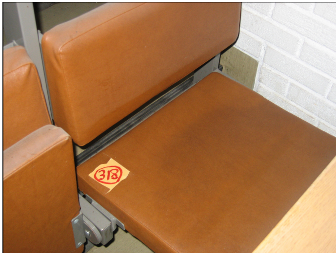
Figur 25: PVC-trekk på klappstol med DEHP-innhold på 260000 mg/kg
