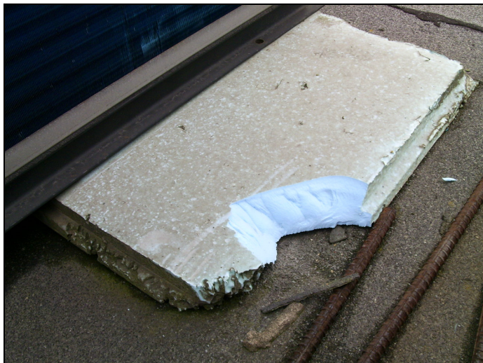
Figur 2: XPS-isolasjonsplate. Den ferske snittflaten viser et homogent materiale uten kulestruktur.
