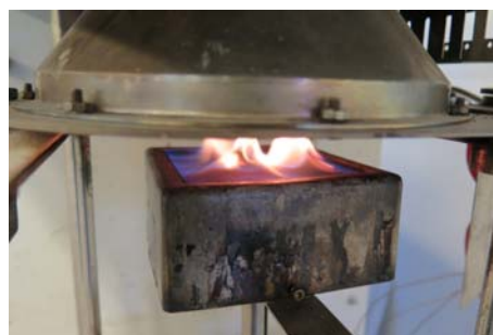
Konkalorimeter ved varmefluksnivå 35 kW/m 2
