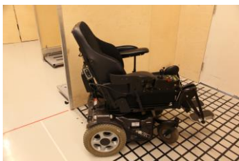
Figur A-6: Eksempel på elektrisk rullestol for begrenset utebruk, med bakhjulsdriфт
