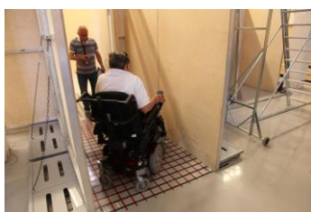
Figur A-8: Eksempel på elektrisk rullestol for innebruk, med midtstilt drivhjul
