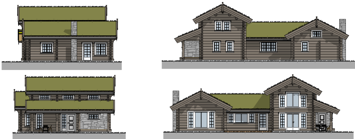
Figur 1: Eksempelhytte brukt til å beregne gjennomsnittlig U-verdi for vinduer og dører opp mot krav i TEK10 § 14-5 fjerde ledd
