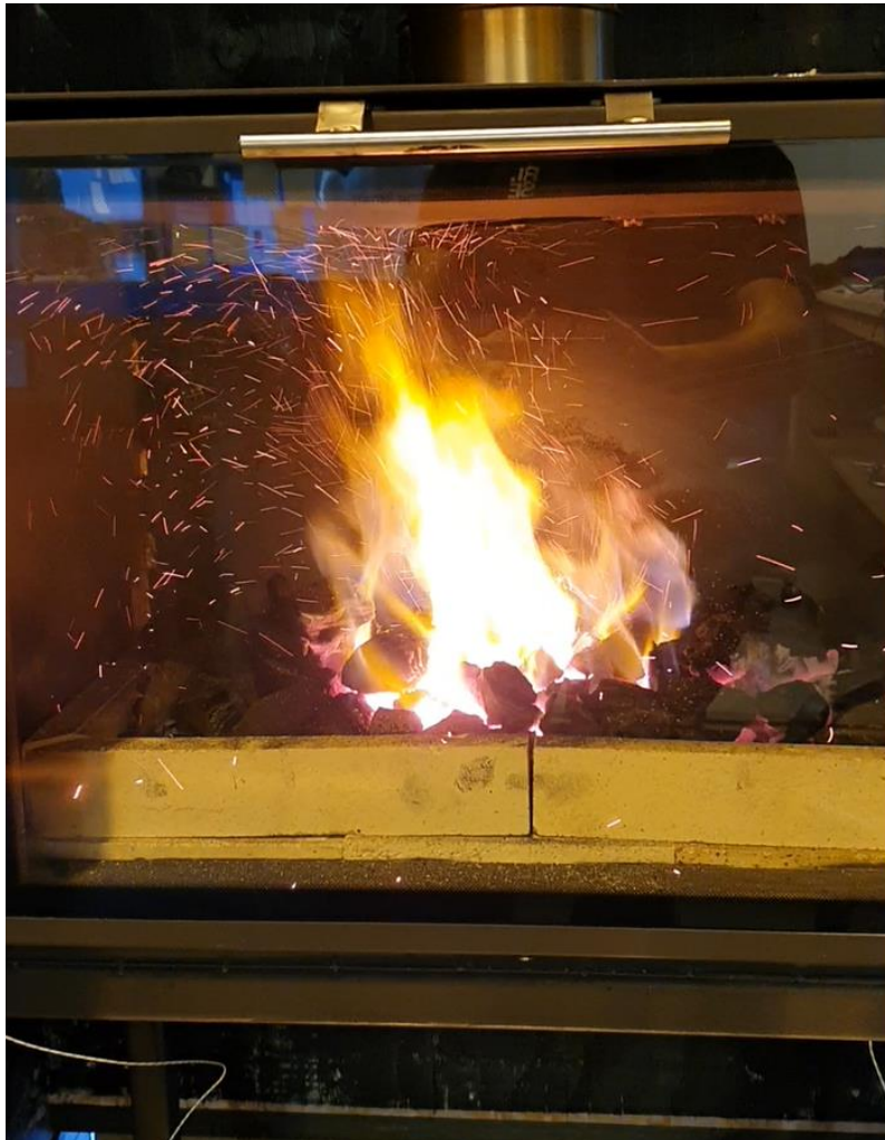
Figur 4-35: Gnistdannelse i lukket testgrill ved test sammen med dummygrill.
