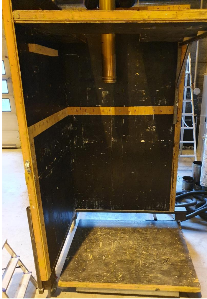
Figur 3-12: Testtriggen bestående av side- og bakvegg, vekt med gulvplate, tak og ventilasjonskanal.
