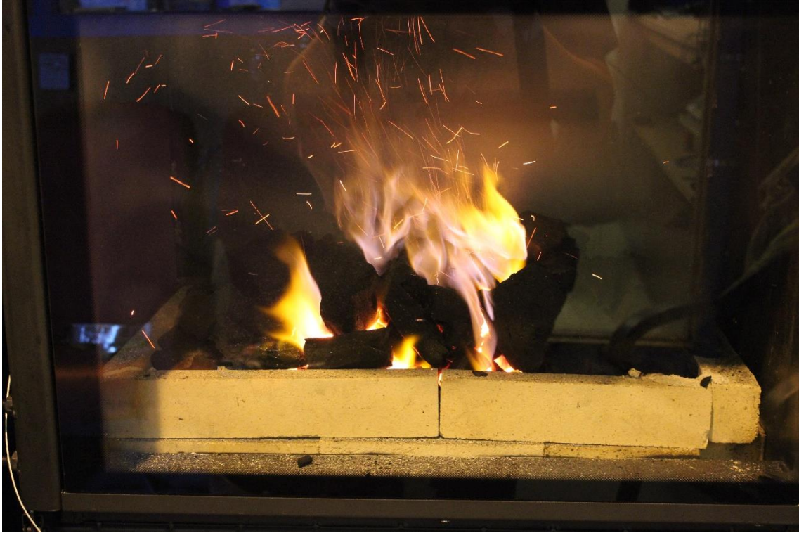
Figur 4-25: Gnistdannelse i brennkammeret, etter nytt ilegg med brensel.
