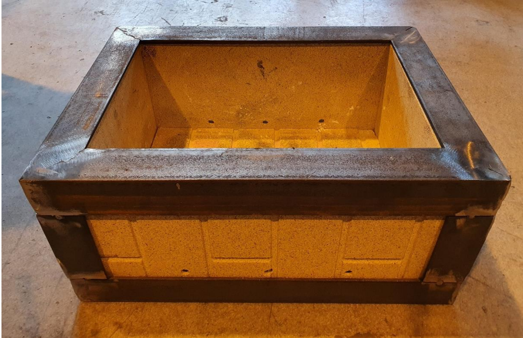
Figur 2-6: Ferdigstilt åpen testgrill med 3 luftehull på begge langsider.
