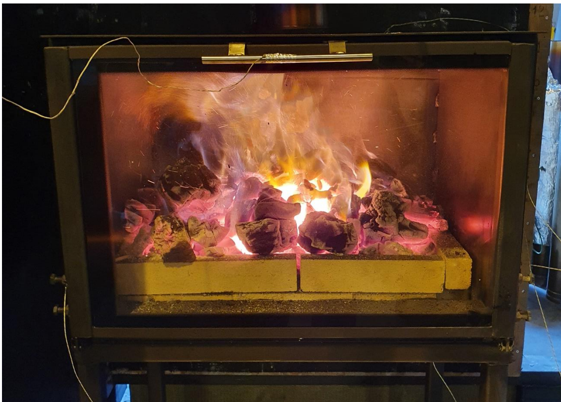
Figur 4-37: Brennkammeret i overfylt testgrill etter ca. 120 minutter.
