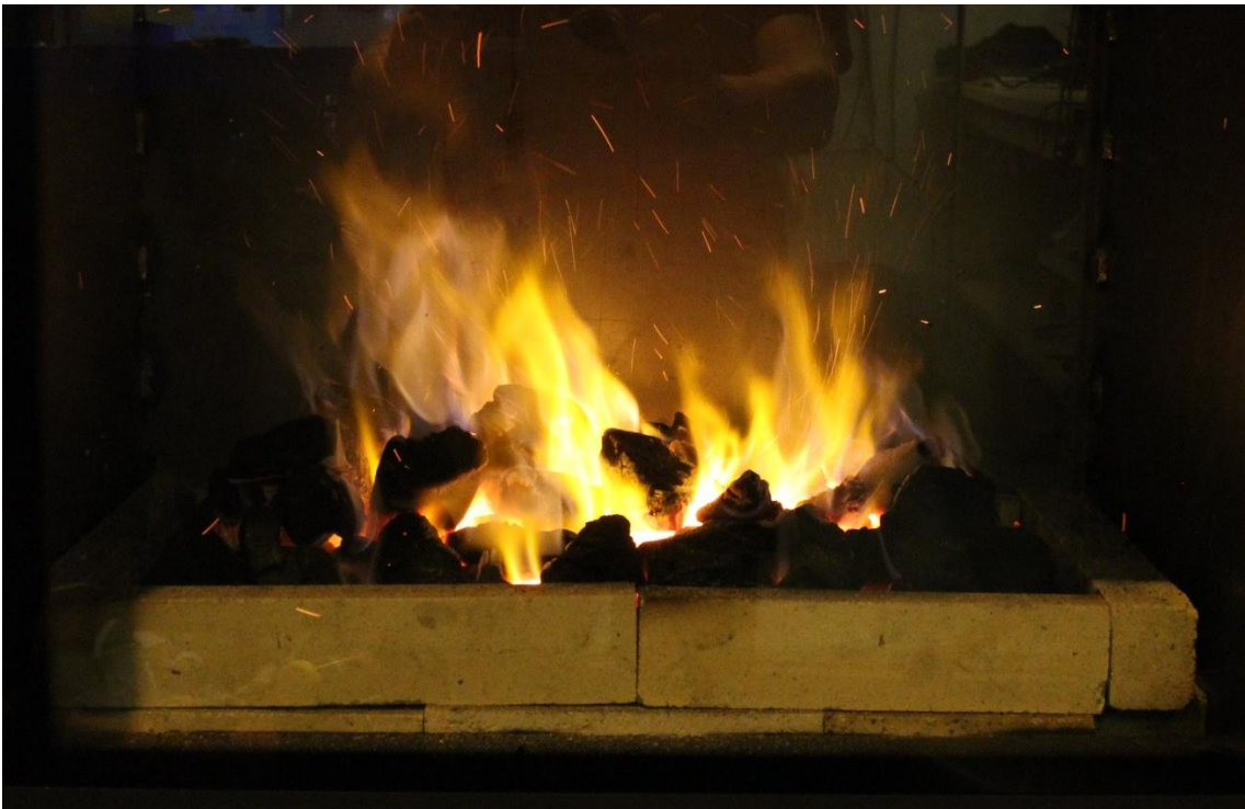
Figur 4-18: Store deler av kullet deltar i forbrenning etter ca. 15 minutter.
